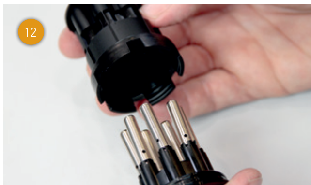
Teraz umieścić na gnieździe styków przedni korpus wtyczki, który musi się słyszalnie zablokować.
