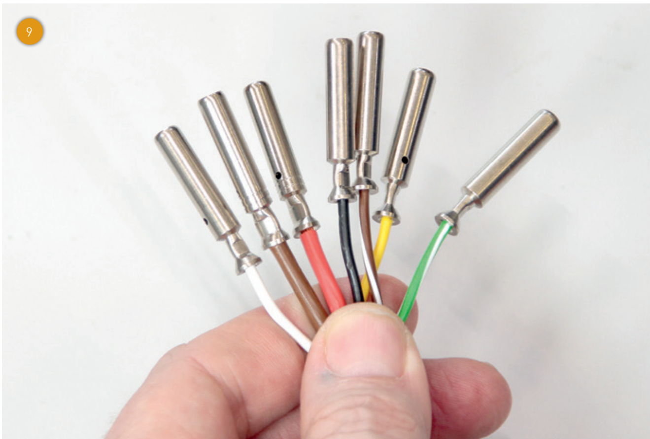
Widok zaciśniętych styków.
