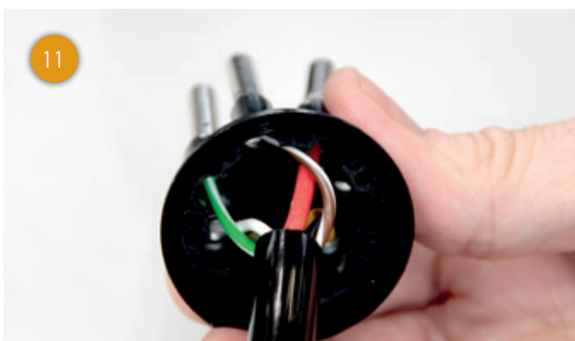
Wprowadzić styki zaciskowe zgodnie ze schematem obciążenia wtyczki do gniazda styków.
