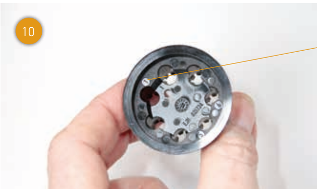
Aansluitschema connectorsysteem ABS/EBS conform ISO 7638
