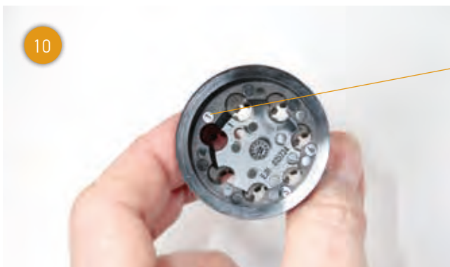
Schema di disposizione del connettore.
