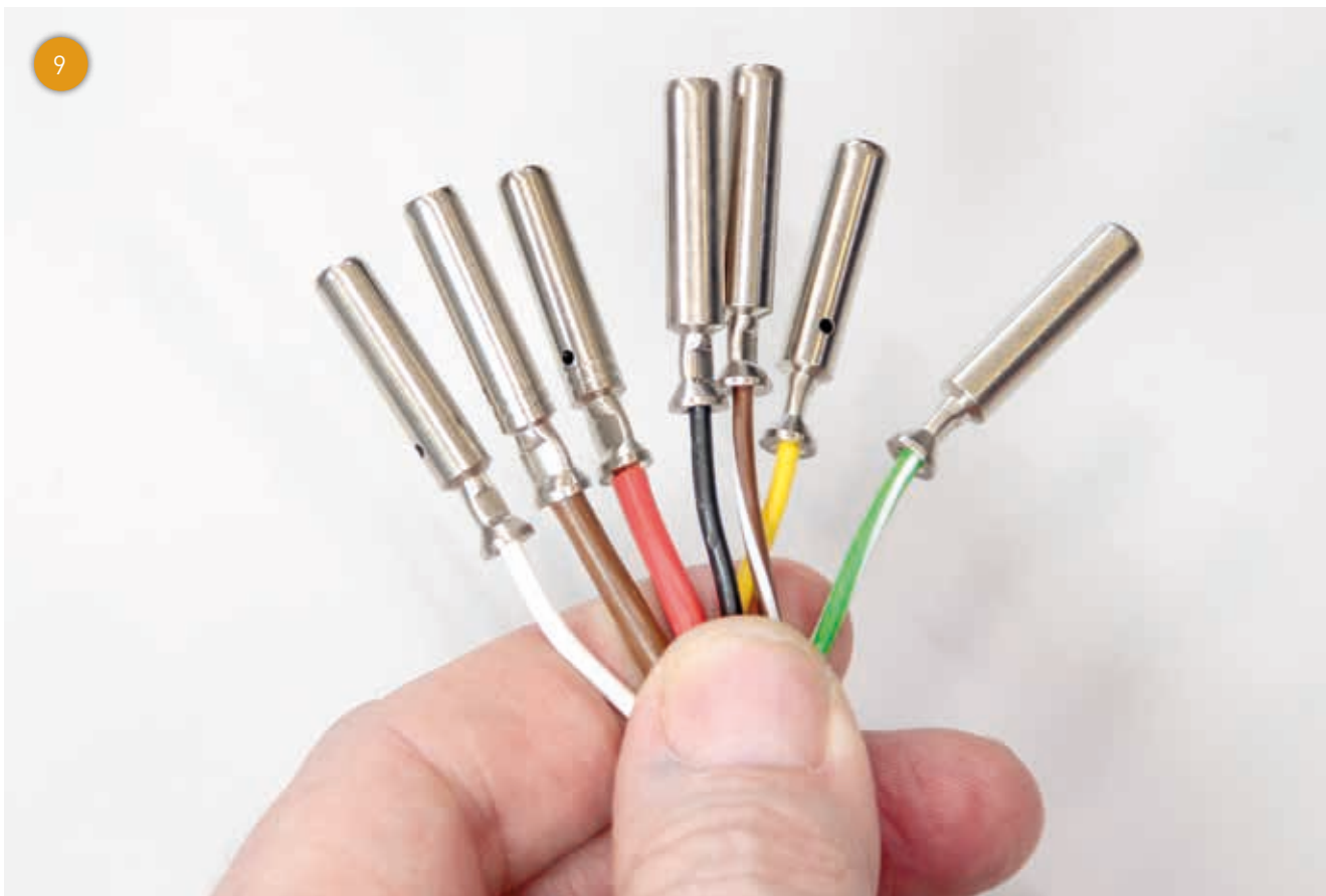
Aspetto dei contatti al termine dell'operazione di crimpatura.
