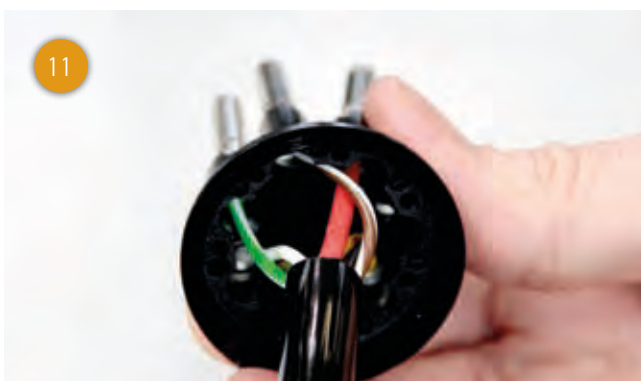
Introdurre i contatti crimpati nel dispositivo di contatto osservando lo schema di disposizione previsto per il connettore.
