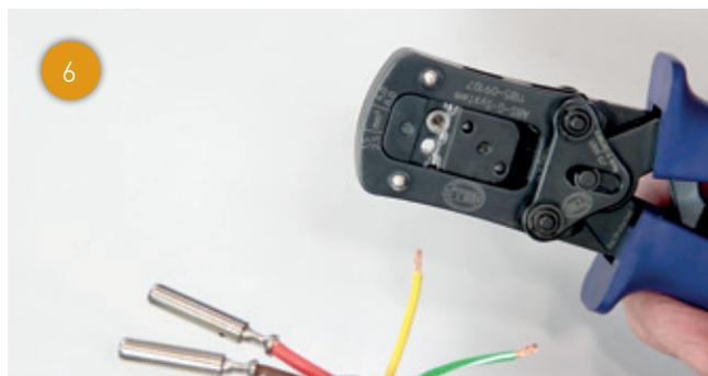
6 ... y luego deberá colocar la junta en el cable. Después, introduzca uno de los contactos para crimpar en el alicate teniendo en cuenta el diámetro del cable.
