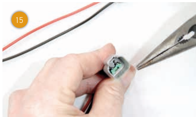
Beim Einsetzen der Sekundärsicherung in das Gehäuse, empfehlen wir die Verwendung einer Spitzzange.
