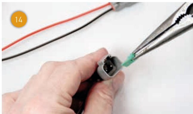
Zur Fertigstellung der Steckverbindung müssen Sie nur noch die Sekundärsicherung bei Stecker und Gehäuse einsetzen.
