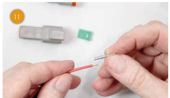
Strip de kabels voor de behuizing eveneens...
