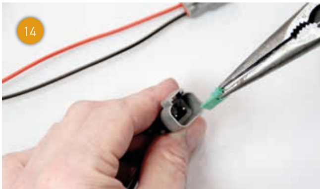
14 Om de stekkerverbinding gereed te maken, hoeft u nu alleen nog de secundaire afdichting in de stekker en de behuizing aan te brengen.
