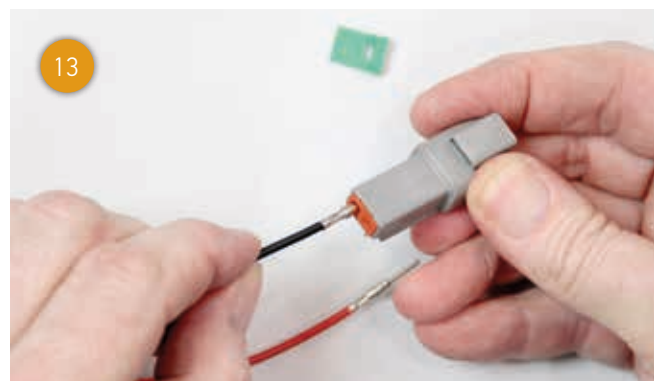
... en steek ook deze nu door de rubberen afdichting van de behuizing tot ze hoorbaar vastklikken.
