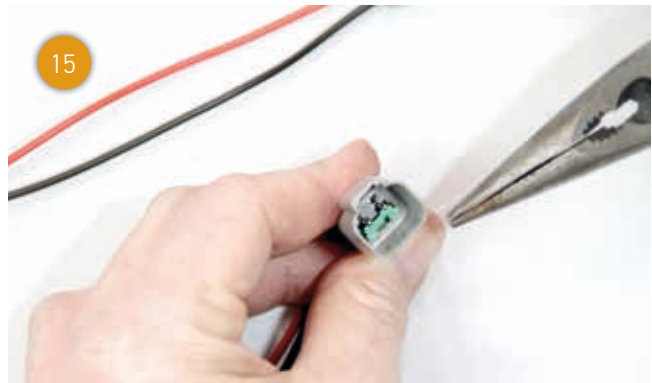
15 Voor het inzetten van de secundaire afdichting in de behuizing adviseren wij u een punttang te gebruiken.
