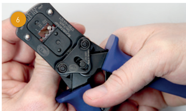
6 ...et le connecteur est mis en place au même niveau que la partie avant dans la pince.
