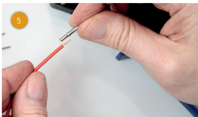
5 Le câble du véhicule est tout d'abord dénudé sur max. 3 à 5 mm au moyen d'un outil adapté ...
