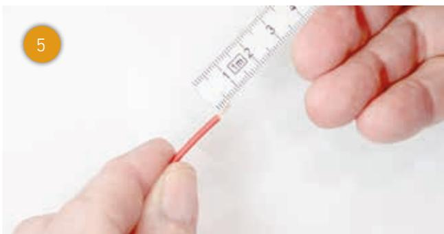
5 Zunächst wird die Fahrzeugleitung max. 5mm mit einem geeigneten Werkzeug abisoliert. Schieben Sie jetzt, unter Beachtung des Kabelquerschnitts, die passende Dichtung auf das Kabel.
