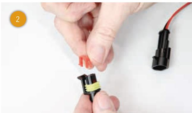
Damit entriegeln Sie im Buchsen- oder Stiftgehäuse zuerst die Sekundärsicherungen.
