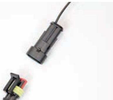
Nachdem auch das dazugehörige Stiftgehäuse mit Kabel und den gecrimpten Stiftkontakten angefertigt wurde, können nun beide Bauteile entsprechend verbunden werden.
