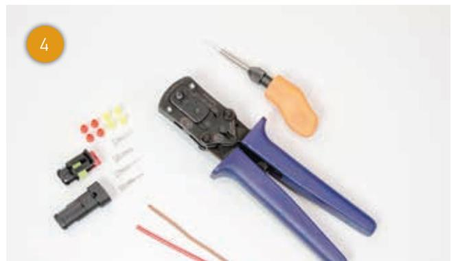
4 Das sind die benötigten Materialien zur Herstellung einer SUPERSEAL-Steckverbindung.
