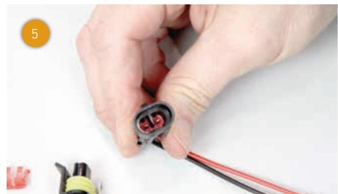
Bei dem **Stiftgehäuse** müssen Sie mit Hilfe des Entriegelungswerkzeugs...
