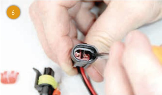
...die Sekundärsicherung heraushebeln.
