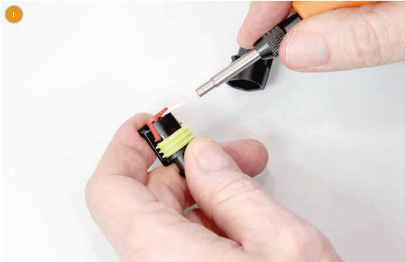
Um eine „SUPERSEAL“-Steckverbindung fachgerecht zu demontieren, nutzen Sie das entsprechende, ebenfalls im Programm verfügbare Entriegelungswerkzeug.
