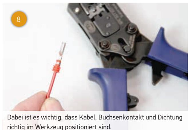
8 Dabei ist es wichtig, dass Kabel, Buchsenkontakt und Dichtung richtig im Werkzeug positioniert sind.
