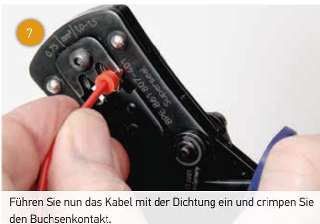
7 Führen Sie nun das Kabel mit der Dichtung ein und crimpen Sie den Buchsenkontakt.
