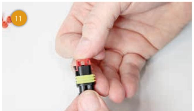
...und anschließend die Sekundärsicherung eingesetzt.
