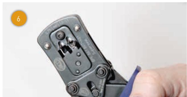
6 Legen Sie anschließend den Buchsenkontakt in die Positionierhilfe der Zange ein. Achten Sie darauf, dass der Buchsenkontakt bündig mit der Werkzeug-Vorderseite abschließt.
