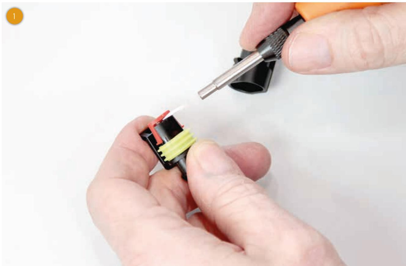
Per smontare correttamente un collegamento a spina "SUPERSEAL", servirsi dell'utensile di sbloccaggio previsto all'uopo, anch'esso fornito in dotazione.
