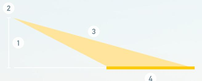
1 Hauteur de montage : l'empreinte lumineuse change avec la hauteur de montage et la nature de l'éclairage. La hauteur de montage optimale est > 2,5 m.
