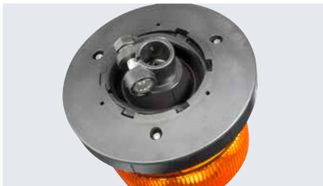
Come funziona tale meccanismo di protezione? Lo zoccolo in gomma si disinnesta dalla dentatura che lo unisce al corpo esterno, evitando che il lampeggiante subisca danni. Se il lampeggiante si piega con un'angolazione eccessiva, può essere riportato nella posizione iniziale allentando le tre viti poste sull'attacco tubolare.
