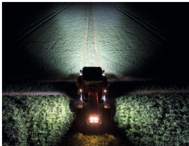
Potencia lumínica claramente mejorada tras el reequipamiento con faros LED. El valor del consumo pudo reducirse hasta los 41,4 A.
