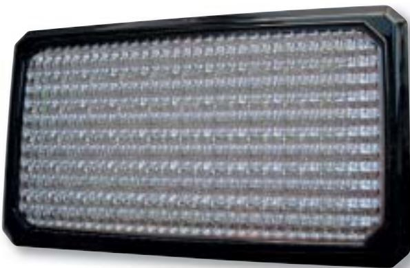
Der hocheffiziente Arbeitsscheinwerfer mit 60 LEDs und flacher Bauform verbraucht lediglich 11 Watt. Um die gleiche Lichtmenge mit Halogenscheinwerfer zu erzielen, werden 70 Watt (z. B. H3) benötigt.
