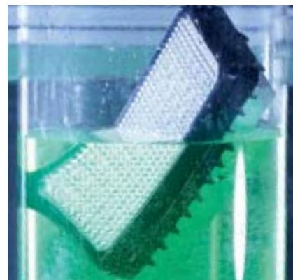
→ Próba zanurzeniowa i próba szczelności
