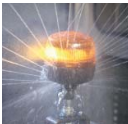
→ Test na pryskającą wodę
