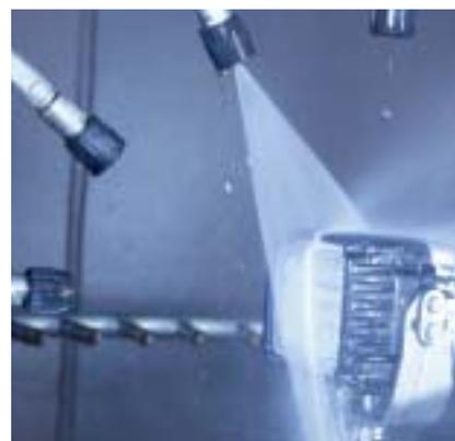
→ Essai de résistance au nettoyage haute pression
