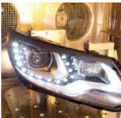
→ Essai thermique, d'humidité et à froid
