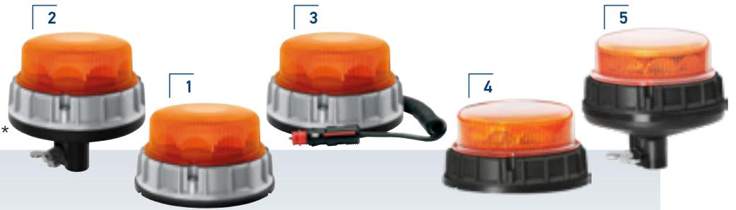
Multivolt 10- 32 V, changement automatique entre le mode jour et le mode nuit, feu rotatif ou clignotant, position de fonctionnement verticale, cabochon en polycarbonate jaune, consommation totale de courant 0,45 A (12 V) à 2,5 A(24 V), consommation électrique moy. 30 W, 72 W max., classe de protection IP 6K7/IP 6K9K, SAE classe 1, homologation ECE-R65 et ECE-R10, CISPR 25 classe 5
