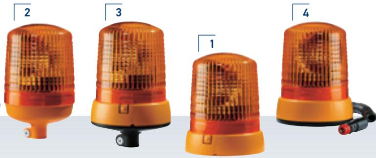
Avec lampe à incandescence H1, feu rotatif, position de fonctionnement verticale, cabochon en polycarbonate jaune, Consommation électrique max. 55 W/12 V, 70 W/24 V et 42 W/230 V, Classe de protection IP 5K4K / IP X9K, SAE classe 2, homologation ECE-R65 et ECE-R10, CISPR 25 Classe 3
