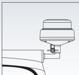
Aufsteckrohr, gewinkelt, mit Sockel zum seitlichen Anschrauben
