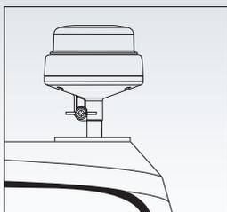
Aufsteckrohr mit Sockel zum Anschrauben
