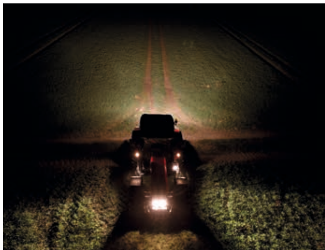
De lichtopbrengst met traditionele halogeenkoplampen vóór de ombouw. De verbruikswaarde ligt hierbij op 60,9 ampère.
