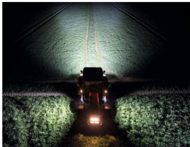
De aanzienlijk verbeterde lichtopbrengst na de ombouw met led-koplampen. De verbruikswaarde is maar liefst tot 41,4 ampère teruggebracht.
