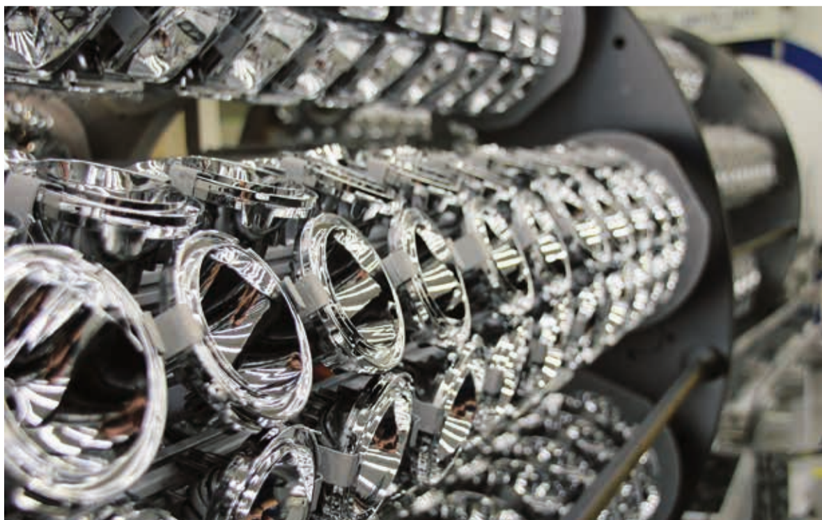
In una camera sottovuoto i riflettori vengono dotati di un rivestimento brillante.
