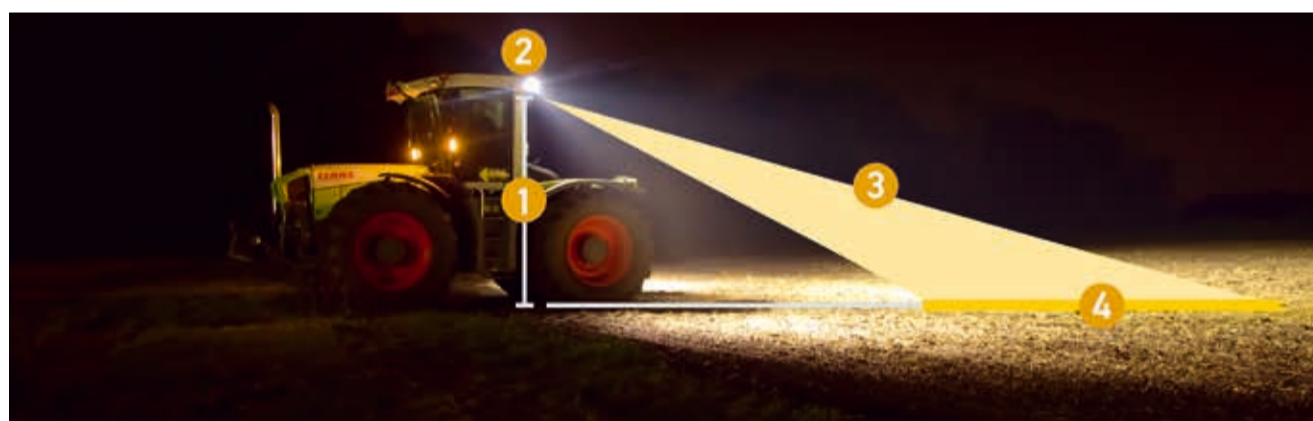
Per ottenere un'illuminazione omogenea, è necessario combinare perfettamente le posizioni dei fari da lavoro. Il giusto abbinamento di proiettori per l'illuminazione a largo raggio e l'illuminazione del campo vicino produce una luce di lavoro ottimale.
