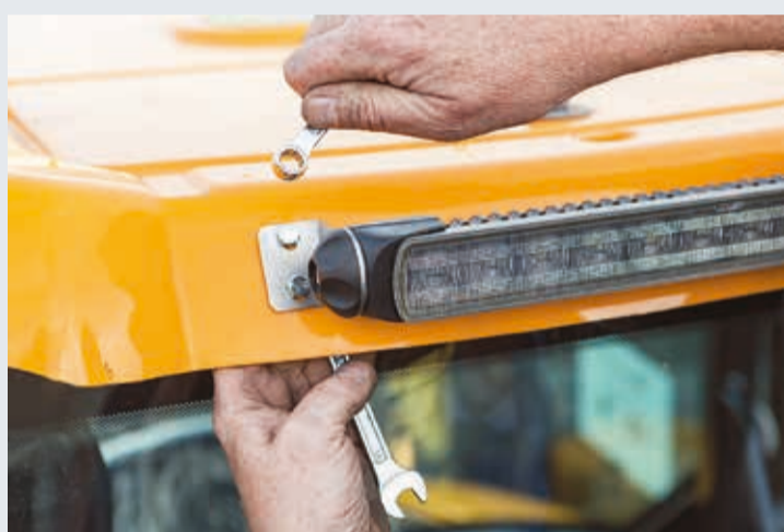
Avvitato saldamente al railing del tetto. Particolarmente resistente alle scosse.
