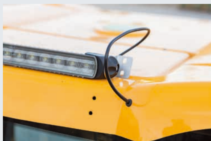
Un faro da lavoro LED Light Bar montato con un set di supporti universali: qui il supporto universale è già stato fissato lateralmente.
