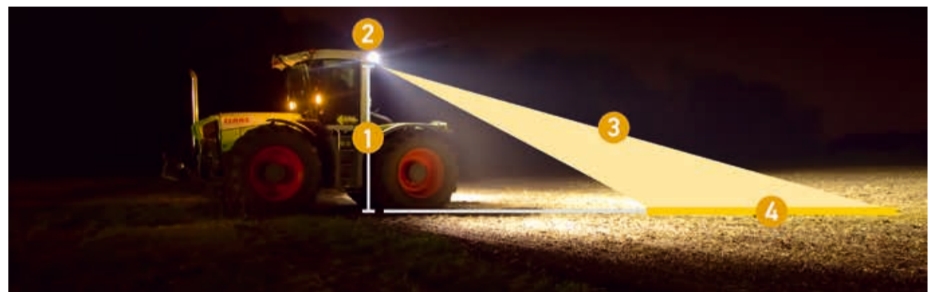
Para lograr una iluminación homogénea, la posición de los distintos faros de trabajo debe ajustarse entre sí. Una correcta combinación entre la iluminación del campo más cercano y la de largo alcance proporciona una iluminación óptima de la zona de trabajo.
